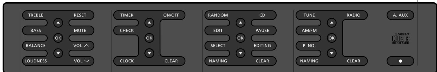
Регулировка звука. Данные кнопки обеспечивают... доступ к функциям регулировки звука: VOL  $\wedge$  и VOL  $\vee$ : Повышение и понижение уровня громкости. MUTE: Отключение звука или активация колонок. TREBLE, BASS, BALANCE и LOUDNESS: Регулировка параметров звука колонок. RESET: Сброс настроек звучания на заводские установки.
