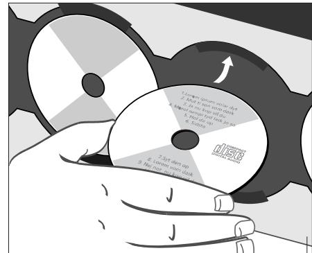
Диск CD необходимо устанавливать стороной с текстом вверх. Удерживая диск CD за боковые кромки, вставьте его в устройство (верхней частью вперед). Для того, чтобы снять диск CD из устройства, возьмитесь за его боковые кромки и слегка надавите на диск в направлении от себя, чтобы освободить его из устройства.
